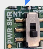
PWR SHR-schakelaar op T, als laatste in de rij (omdat er maar 2 laders in het systeem zitten)
