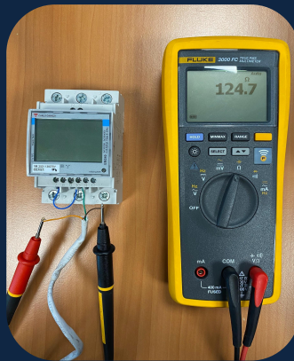
Weerstand kabel aan meter kant
