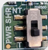
PWR SHR schakelaar op T, als eerste in rij
