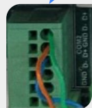
Bedrading aangesloten op D+, D-, GND
