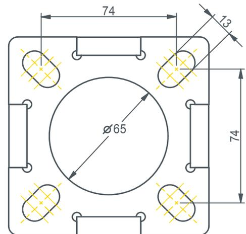
Percez 4 trous dans le socle en béton.
