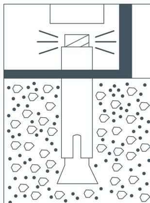
Serrez les écrous des ancrages à béton.
