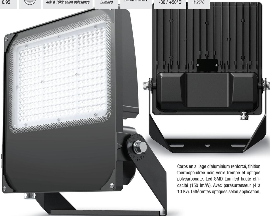
Corps en alliage d'aluminium renforcé, finition thermopoudrée noir, verre trempé et optique polycarbonate. Led SMD Lumiled haute efficacité (150 lm/W). Avec parasurtenseur (4 à 10 Kv). Différentes optiques selon application.
