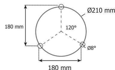
Schéma de pré-perçage
