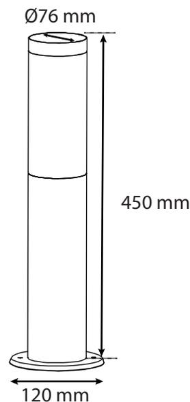
Pour les applications extérieures, un système de drainage doit être utilisé sous le socle d'encastrement pour faciliter l'évacuation des liquides.
