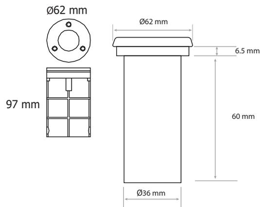
Pour les applications extérieures, un système de drainage doit être utilisé sous le socle d'encastrement pour faciliter l'évacuation des liquides.
