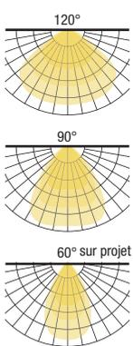
Corps en aluminium, design fin et compact, grande légèreté et dissipation thermique maximale. LED SMD haute efficacité, dimmable 0-10 volts. Eclairage 90° et 120° (standard), et 60° (sur projet).
