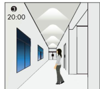
Lorsqu'un mouvement est détecté, la lumière s'allume au niveau de luminosité du temps de maintien.
