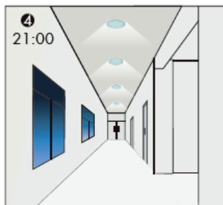
La lumière s'allume automatiquement à nouveau au niveau faible lorsqu'aucun mouvement n'est détecté.
